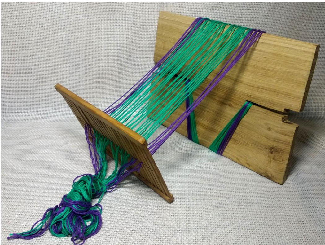
Рис.55. Намотування основи на дошку
