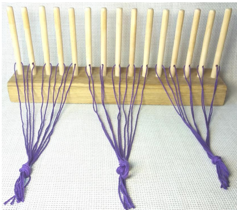
Рис. 59. Кілочки з протягненими в отворах нитками основи
