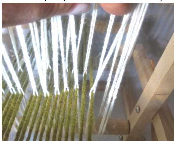
Рис. 66. Пробирання ниток основи в ремізки
