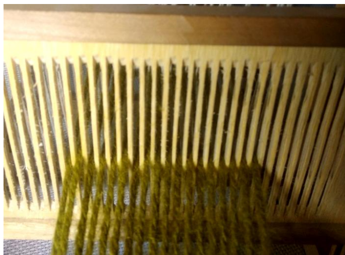
Рис. 65. Пробирання ниток основи в бердо
